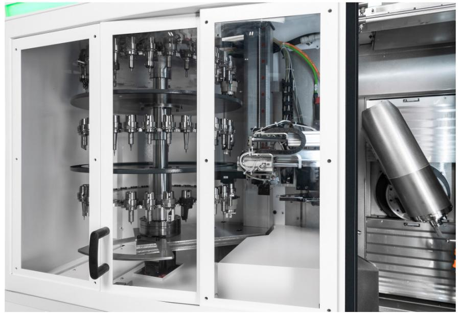
Equipée de périphériques « à la carte » tels que haute pression contrôlée en température, convoyeur de copeaux et embarreur Bumotec ou de standards connus de nos clients, la modularité de la 191<sup>neo</sup> permet de satisfaire la totalité des exigences clients. Au-delà du tournage et du fraisage, la rectification, le polissage, le skiving, le taillage par génération et le diamantage sont acquis et permettent de terminer chaque pièce complexe et exigeante en un seul serrage.
