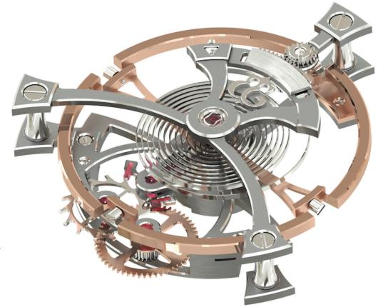
condes comme c'est souvent le cas. Pour entretenir sa fréquence de 18'000 alternances par heure (2,5Hz) et pour garantir une réserve de marche de 54 heures disposant de son propre indicateur, le remontage recharge en énergie 4 barillets montés en parallèle et se transforme en un geste-rituel: par le fond, grâce à une clef tournante impactant une roue centrale montée sur roulement à billes.
