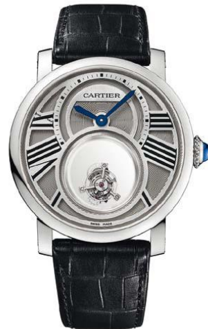
2013. Spécialiste historique des pendules et pendulettes mystérieuses, Cartier propose une montre-bracelet basée sur le même principe. Dans ce cas, un tourbillon volant 1 minute bat à l'intérieur d'une chambre de saphir effectuant elle-même une rotation complète en 5 minutes. Système breveté. Poinçon de Genève.
