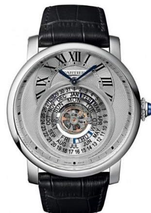
2014. La montre Rotonde de Cartier Astrocalendaire contient un mouvement mécanique à remontage automatique 9459 MC doté d'un tourbillon et d'un quantième perpétuel à affichage circulaire.
