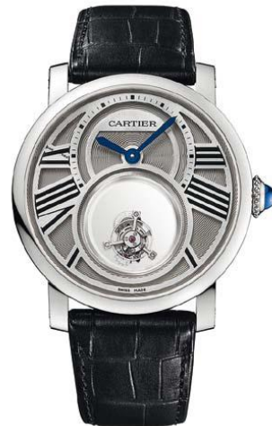
2013. Als namhafter Spezialist für sogenannte „mysteriöse“ Pendulen und Penduletten präsentierte Cartier eine Armbanduhr, die auf dem gleichen Prinzip basiert. In diesem Fall dreht ein fliegendes Tourbillon, das in einer Minute eine Umdrehung vollzieht, in einer Saphirkammer, die ihrerseits eine vollständige Umdrehung in fünf Minuten vollführt. Patentiertes System. Genfer Siegel.
